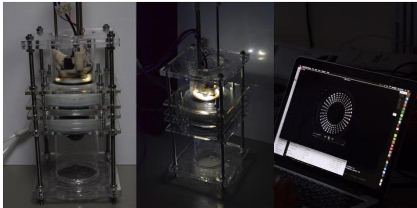
FIGURE 5 TACTIP CAPSULE INSIDE LEEDS SIMULATION RIG
